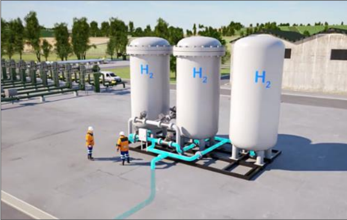
Bild 4-10. Exempel på trycksatta lagringsbehållare för lagring av vätgas. Källa: Hybrit. Exempel på en trycksatt vätgasbehållare finns nedan.
